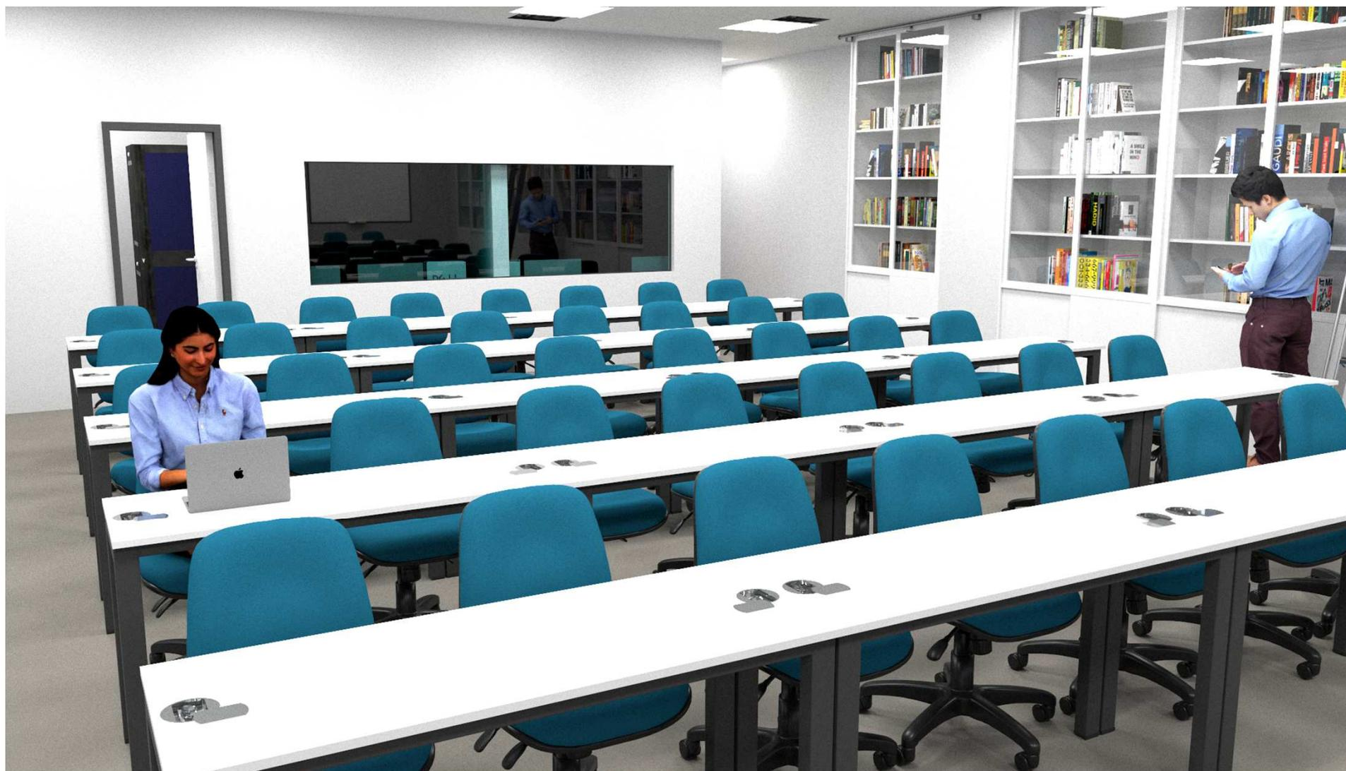
Mesas em MDF branco, base em tubo de aço com acabamento em pintura epóxi-pó cinza, pontos de tomada e dados no tampo
