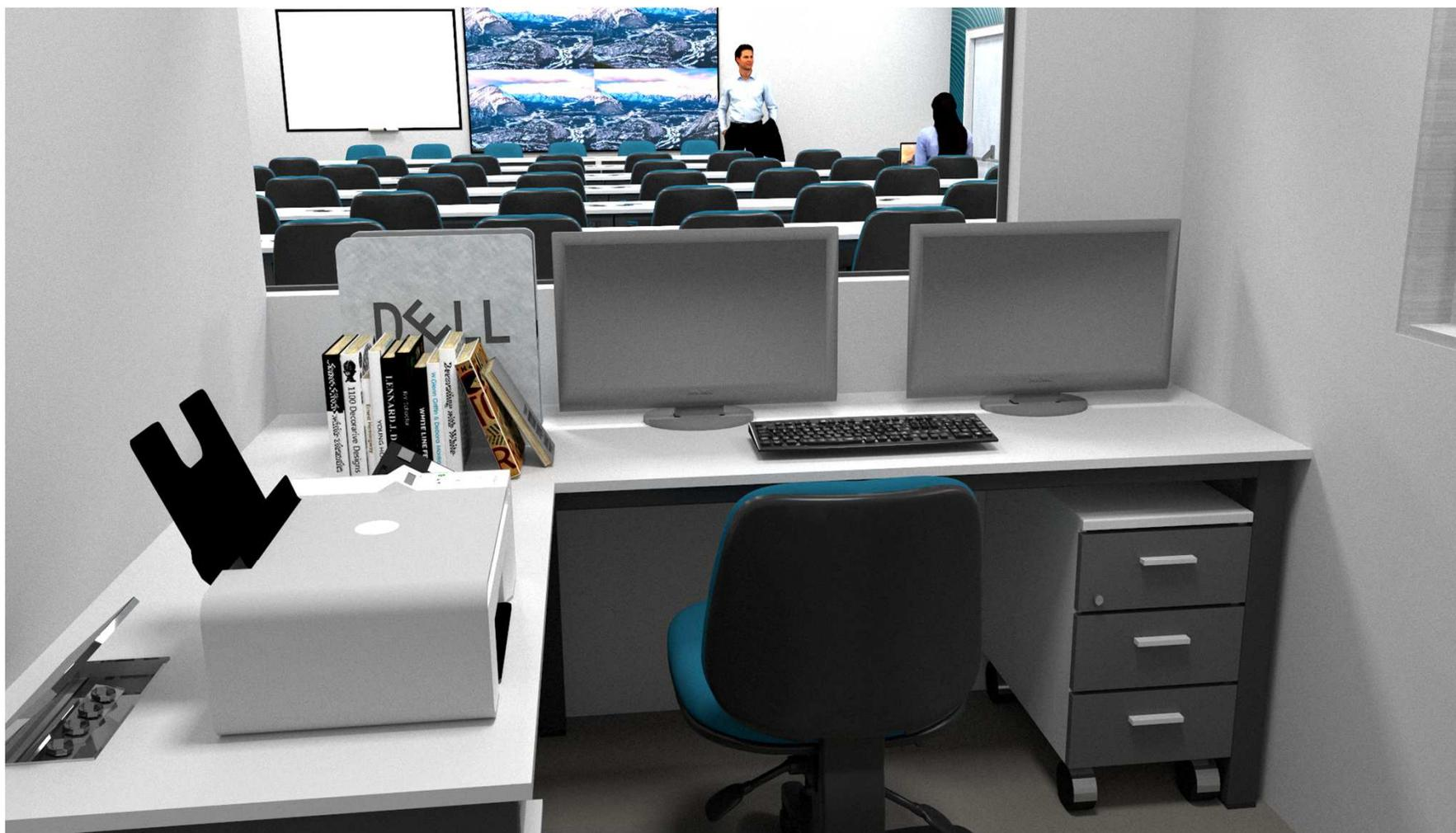
Coordenação. Uma estação de trabalho separada por uma parede com comunicação visual conforme manual, em MDF e base em aço com pintura epóxi-pó cinza. Com visão para a sala de aula por vidro e uma janela com visão da sala de Áudio/Vídeo.
