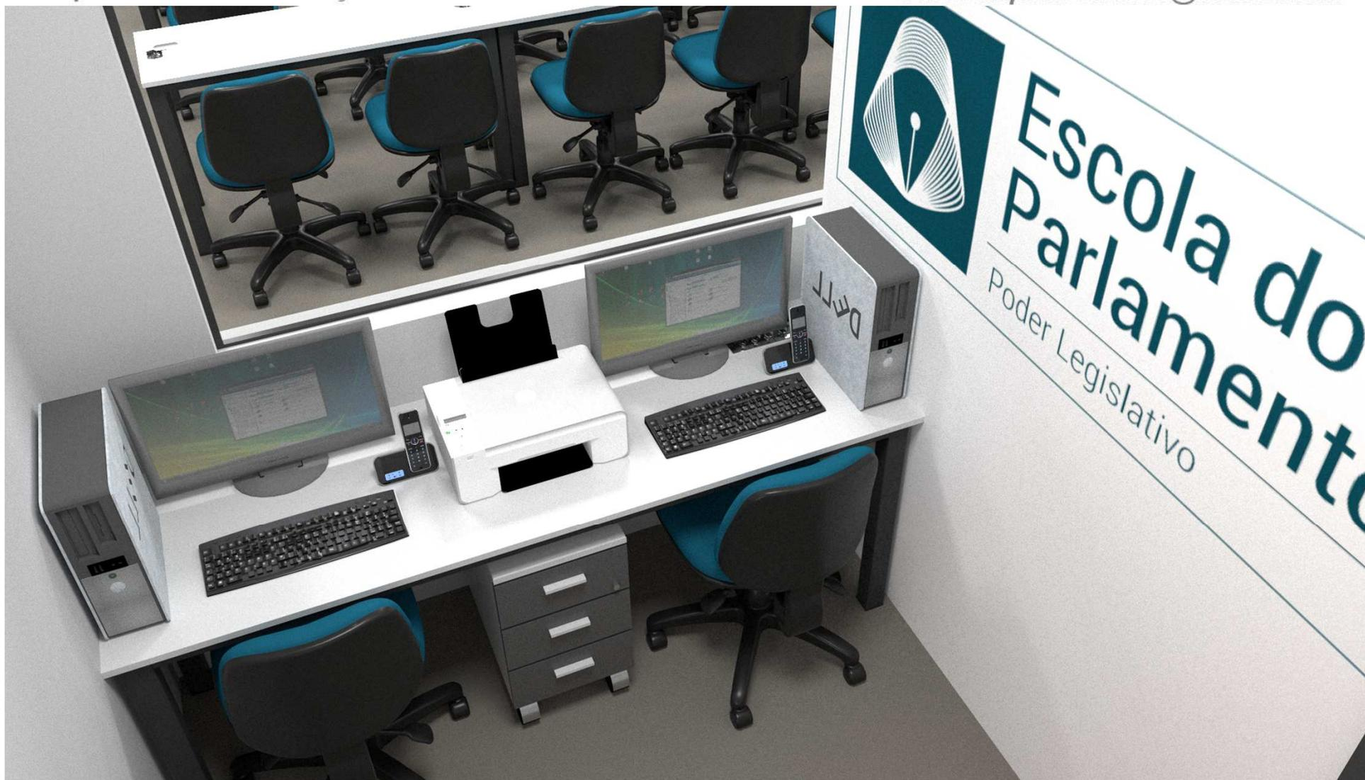
Coordenação. Uma estações de trabalho para duas pessoas, em MDF e base em aço com pintura epóxi-pó cinza. A coordenação tem visão da sala de aula por um vidro
